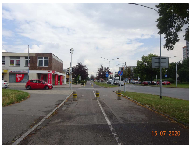
Obr. 3: Stávající nevhodně umístěné betonové sloupky v rozdělené stezce pro chodce a pro cyklisty.
